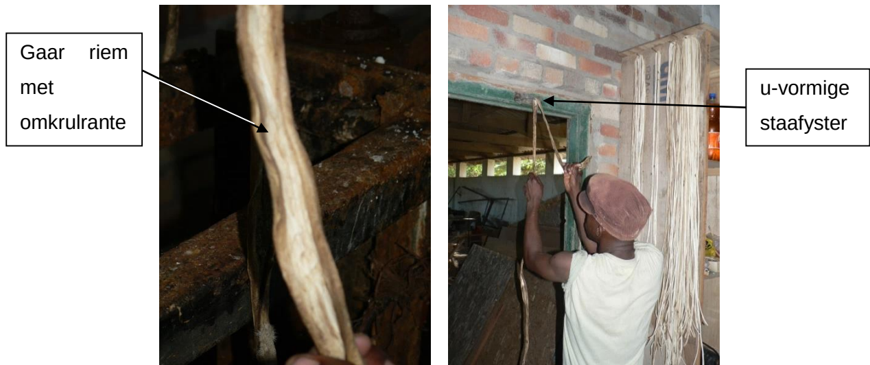
Figuur 8-13: Oopvlek van klaar gebreide riem met omkrulrante links. Oopvlek oor u-vormige staafyster (6 mm dik) Marius Oosthuysen-fotoversamling
