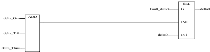
Pre-fault Actual Transfer Angle
