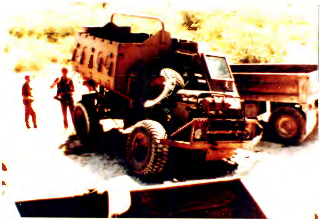
Illus. 91: 'n Buffel mynbestande troepedraer wat 'n landmyn in die noorde van Namibië gedetoneer het. Spesiale pantserstaal wat deur ISCOR vervaardig is en die v-vormige bak gedeelte het baie die lewens van baie Suid-Afrikaanse soldate gespaar.
