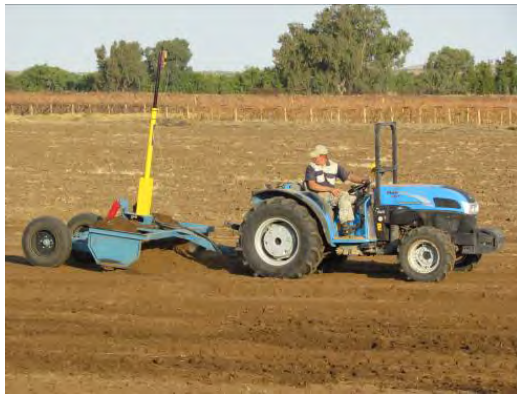
Figuur D1: Lasertegnologie word ingespan met gelyksleep van grond. 21
