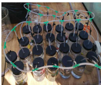
Figuur C-18: Voorbereiding van glasbotteltjies vir ontbindingseksperiment
