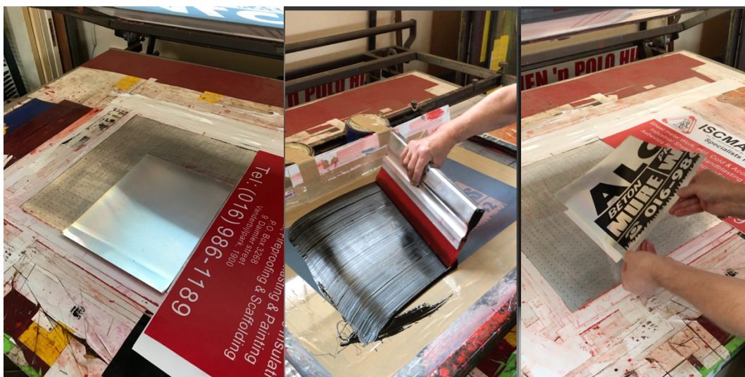
Figuur 39: Aluminiumplaat en syskermdruk
