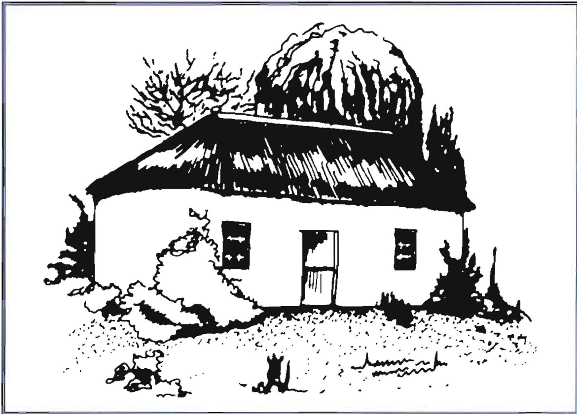
Illustrasie 31 Die pionierswoning ( \pm 1848 ) Hartbeespoort. 249 Let op die bootvormige saaldakhuiskonstruksie. Die drievertek 1-plan, hieronder, bestaan uit 'n sentrale woonvertrek (voorhuis) en twee slaapvertreke aan weerskante. Skets: C. Gouws.
