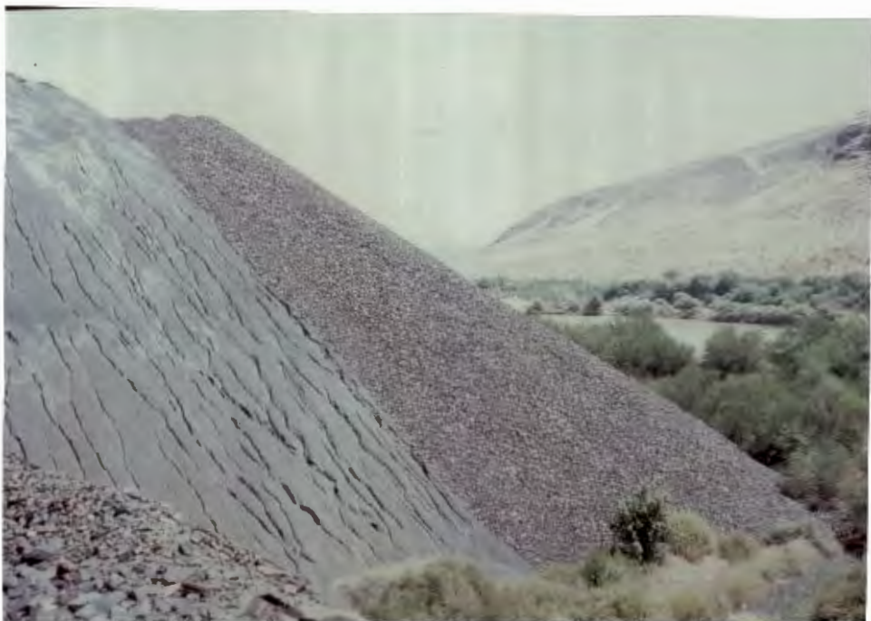
Plaat 3.5: Donga-erosie teen die kante van 'n andulosiet uitskothoop
