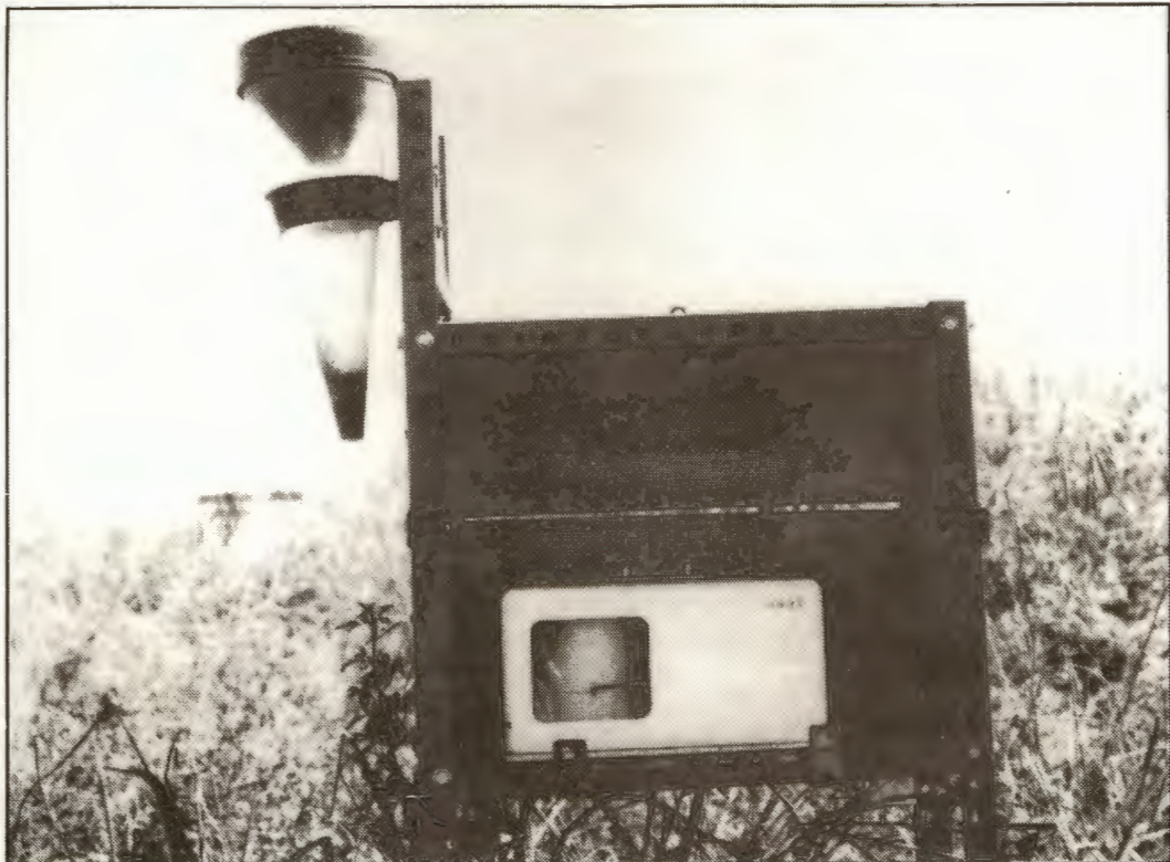
DIE TERMOGRAAF IN 'n TOESLUITBARE KASSIE MET DIE REËNMETER LANGSAAN GEMONTEER OP PERSEEL C.
