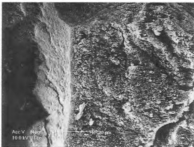
Mikrofoto 4.7 SEM-foto van polifenielasetileen wat by 120 °C in die teenwoordigheid van \text{Mo}(\text{CO})_6/\text{C}_6\text{H}_{10}\text{O} berei is.
