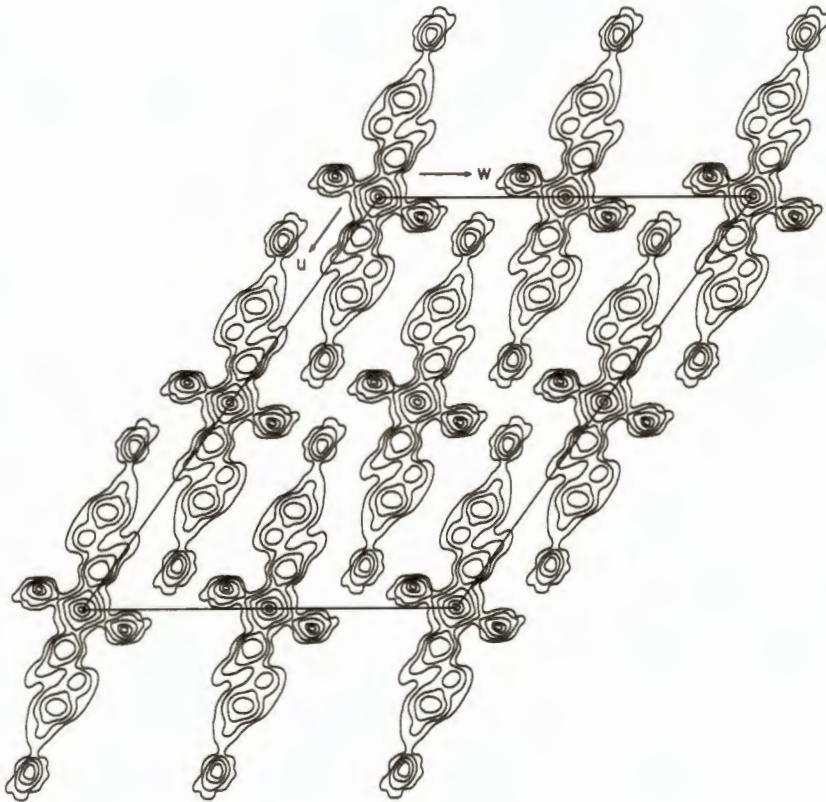
FIGUUR 3.5 [010]-PATTERSON-PROJEKSIE VAN ALFA- \text{Zn}(4\text{-CPy})_2\text{Cl}_2 ; KONTOERE IS VIR GELYKE MAAR WILLEKEURIGE INTER- VALLE GETREK
