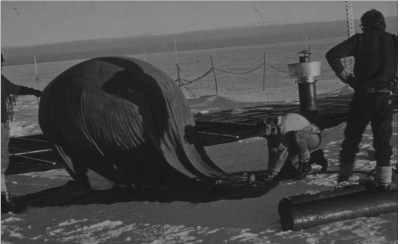
'n Rubberballon word opgeblaas om 'n detektor vir waarnemings van energieke elektrone in die troposfeer tot hoogtes van 10 000 meter op te neem. Verskeie personeel van die destydse Departement Fisika was verantwoordelik vir die maak van die detektor en sender, wat die data teruggesein het (Bron: H. Moraal)
